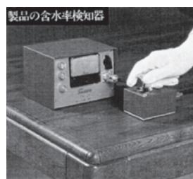
図 22 含水率試験 ( '79 カタログ)
