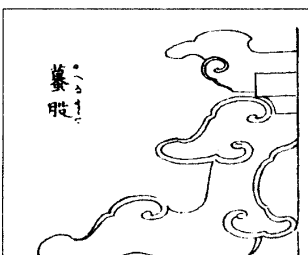
図 2-36 : 墓股 / 肩・腰内側に渦付木鼻が付いている。枳内は格狭間になっている。
